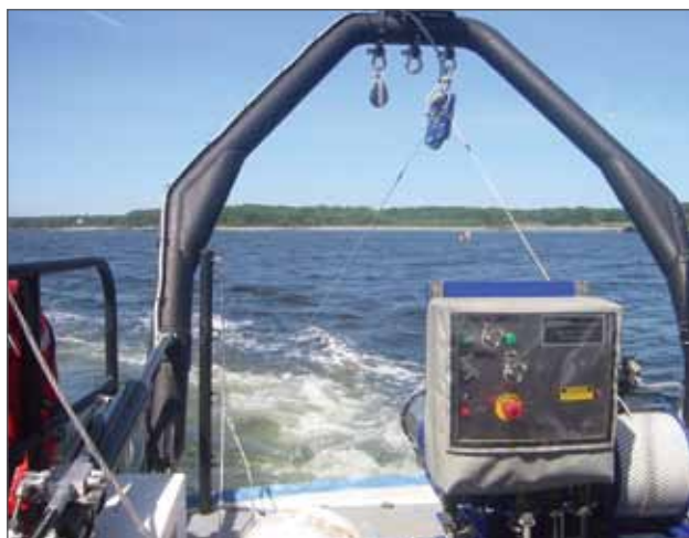
Figure 1-8. Winch on R/V Cocheco.
